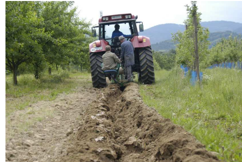
Abb. 5: Nachbaufähiger Pflug zum Anlegen eines etwa 50 cm tiefen Grabens (links). Das Gerät wird an einem Schlepper mit hydraulischem Querlenker angehängt (rechts).
