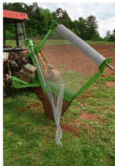
Abb. 6: Das Gerät zum Verlegen des Drahtes (links) wird in den gezogenen Graben eingesetzt. Durch die Fixierung mit der lockeren Erde im Graben rollt sich das Barrierematerial automatisch ab.
