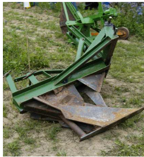
Abb. 5: Nachbaufähiger Pflug zum Anlegen eines etwa 50 cm tiefen Grabens (links). Das Gerät wird an einem Schlepper mit hydraulischem Querlenker angehängt (rechts).
