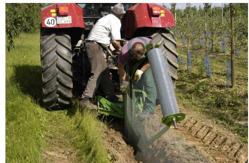
Abb. 6: Das Gerät zum Verlegen des Drahtes (links) wird in den gezogenen Graben eingesetzt. Durch die Fixierung mit der lockeren Erde im Graben rollt sich das Barrierematerial automatisch ab.
