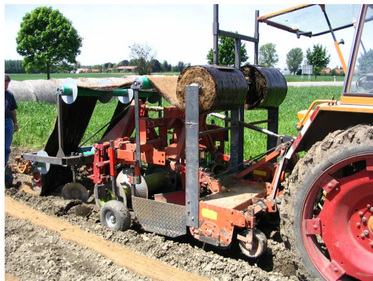
Abb. 3: selbstgebautes Kombigerät zur Dammerstellung und Kokosfasermatten-Verlegung
